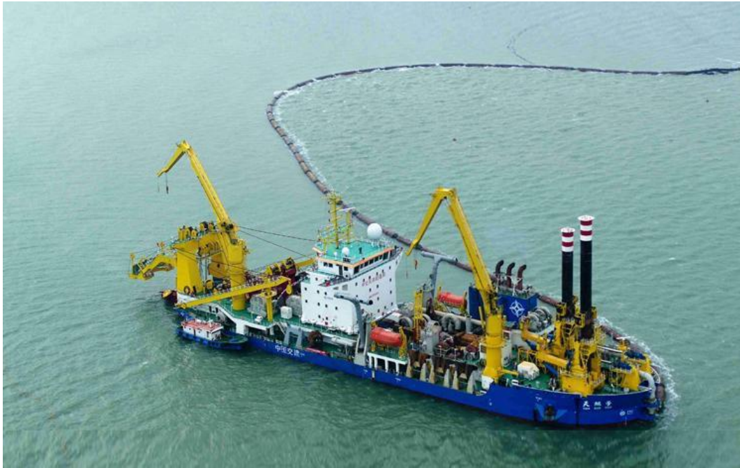
图2.3.4-4 绞吸船施工示意图
